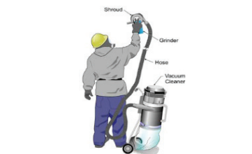
그림 1. 콘크리트 그라인딩에 적합한 이동식 국소배기덮개 (출처: Workplace Solutions, NIOSH 2009)
