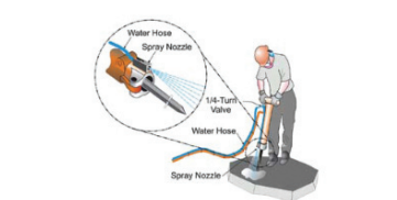
그림 2. 스프레이 노즐이 부착된 잭햄머(콘크리트 파쇄작업에 적합) (출처: Workplace Solutions, NIOSH 2009)
