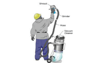
그림 1. 콘크리트 그라인딩에 적합한 이동식 국소배기덮개 (출처: Workplace Solutions, NIOSH 2009)
